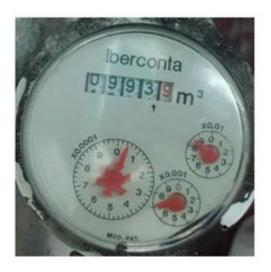
En un contador de agua como el que vemos en la fotografía, las ruedecillas van girando conforme se gasta agua y, al mismo tiempo, este gasto va reflejándose en los números del rectángulo que hay en la parte superior del contador.
